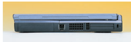
写真3 本体右側には、TYPEのPCカードスロット×2と、モデム用モジュラーコネクタがある。
