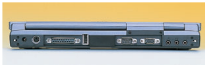
写真2 PS/2、パラレル、USB、シリアル、アナログRGB出力の各コネクタが付いている。
