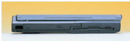
写真1 本体左側には、24倍速のCD-ROMドライブと3.5インチフロッピーを内蔵している。
