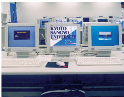
写真3 Linux/NTのデュアルブート環境。左にLinux、右にNTの起動画面が表示されている。センターにあるモニタは講師の画面を表示するためのもの。
