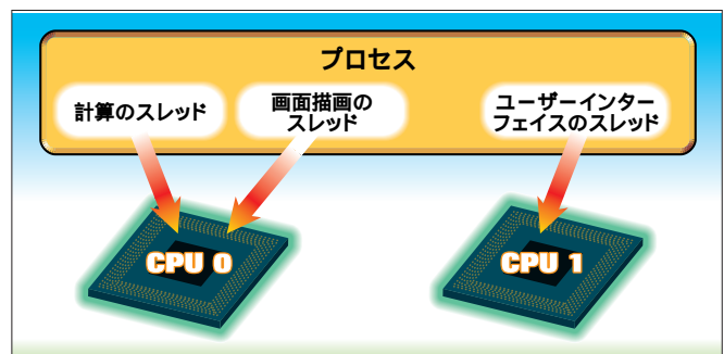
図2 SMPに対応したマルチスレッドOSでは、スレッド単位でも各CPUに仕事を割り振る。たとえば、計算と画面描画、ユーザーインターフェイスの処理を別スレッドにすれば、計算と描画を同時に行いつつ、ユーザーからの入力を受けられる。
