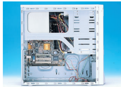
写真10 マザーボード、CD-ROM、ハードディスクをケースに取り付ける。コネクタ類やCPUは、電源部分の奥になる。
