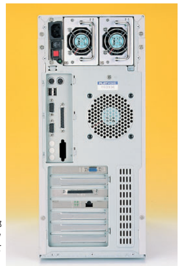
写真2 ケース背面パネル。電源部のほかに背面パネルにもファンが取り付けられていてCPUの冷却を助けている。
