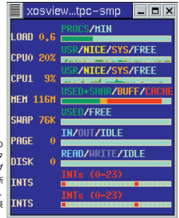
画面2 xosviewはマシンのリソースをリアルタイム表示するXアプリケーション。最新版はSMPに対応し、CPUごとの負荷を表示する。
