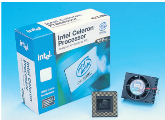
写真1 CPUはCeleron366のSocket370タイプ、リテール版を購入。クロックは66MHz x 5.5倍で動作する。
