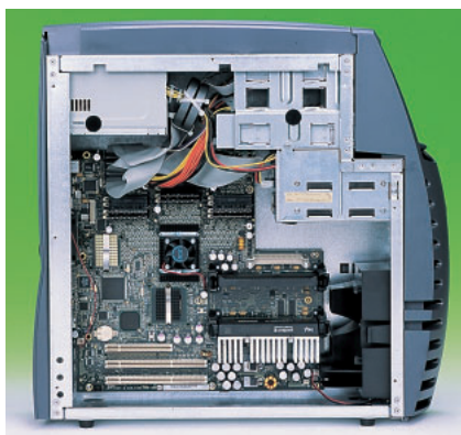
写真1 Visual Workstationは、Pentium を搭載したWindows NTマシンだ。しかし、専用チップセットにより驚異的なグラフィックス性能を誇っている。
