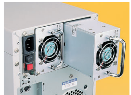
写真4 電源部は2重化されており、もし片方が故障しても通電状態のまま交換可能。
