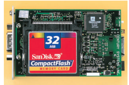
写真3 マザーボードのCFカード装着面 コンパクトフラッシュではなく、1GバイトのMicrodriveを装着すれば大容量のデータを格納できる。
