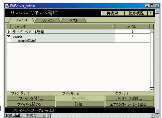
画面2 サーバリモート管理画面 ファイルメーカーPro 5.5上からファイルメーカーServer 5.5をリモート管理できる。共有DBの指定を行う。
