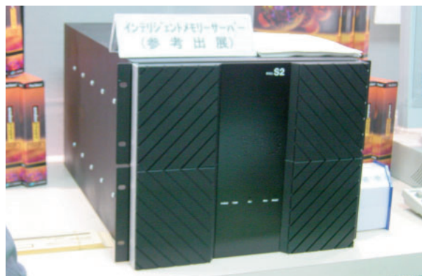
NTTコムウェアが参考出品した「Intelligent Memory Server」は、32Gバイトのメモリを内蔵し、データ領域をディスクの代わりにメモリで処理することで高速データ処理を実現する。
