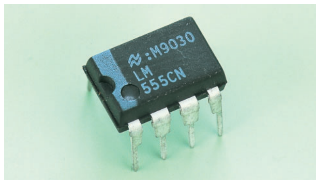
写真5 LM555 40kHzを発振させるために使ったタイマIC。
