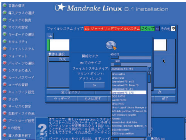
画面1 Mandrake Linuxのインストーラ インストーラのパーティション設定画面では、Mandrake Linuxがサポートするファイルシステム、ext2、ext3、ReiserFS、XFS、JFSを使ってパーティションを作成できる。
