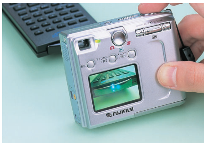
写真2 デジカメで赤外線LEDの状態を見る 肉眼では見えない赤外線LEDの状態を確認できる。
