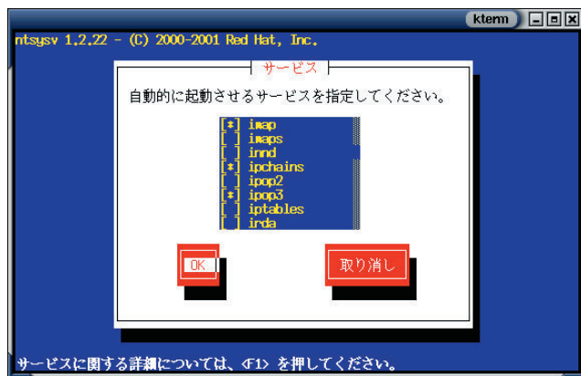
画面1 ntsysvでサービスを有効化する POPやIMAPだけでなく、あらゆるネットワークサービスのオン/オフを制御することができる。
