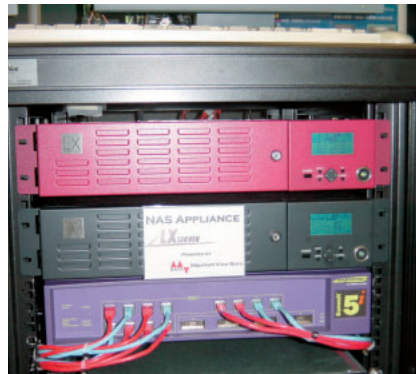
ランスの2UラックマウントタイプのNASアプライアンスサーバ「Lx-Server」は、内蔵する「KEGON」という独立したワンボードPCがシステムの状況を監視し、前面のLCDモニターに表示、トラブル時の自動制御を行う。
