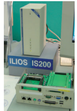
日立ソフトのネットワークアプライアンス「ILIOS IS200」は、195 (W) × 148 (D) × 80 (H) mm、2.3kgと小型ながら3.5インチHDD内蔵で、100BASE-Tポートを2ポート備え、Red Hat 7.1も動作確認済み。
