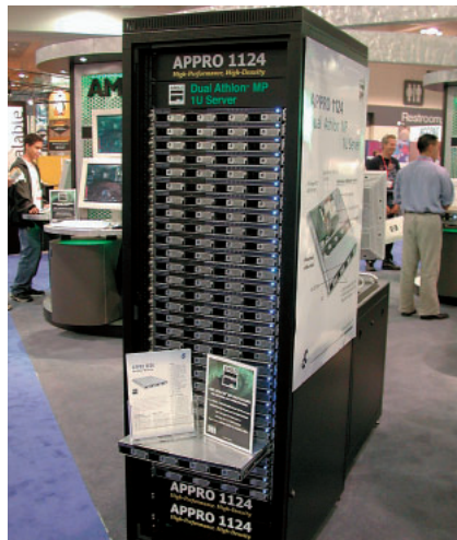
AMDのブースに展示されていたAppro社のデュアルAthlon 1Uサーバ「Appro 1124」。1Uユニットの中に、Athlon 2個のデュアルCPUのマザーボードとHDD 4台からなるRAIDディスク装置をすべて納めた高密度、高性能サーバ。
