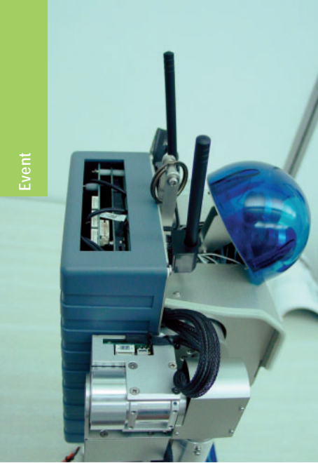
(左から順に) ロボットの背中ボックスに、オプションの中央制御ユニット、バッテリー、拡張基盤を収納する ロボットの脚部背面。モーターが密集している 足の裏には四隅に足底感圧センサが 頭部の目玉には2つの無線カメラが配置されている
