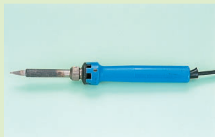
写真B セラミックヒータを使用した半田ゴテ
