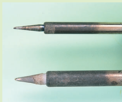
写真C コテ先の太さで、扱いやすさが違うので、用途に合わせた選択をすべきだ
