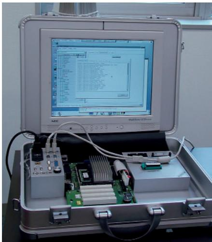
写真1 TSEの開発環境と、開発したシステムをストレージにコピーする機能を一体化した「TSE Toaster」
