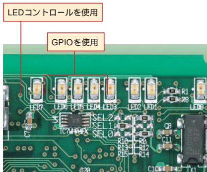
写真3 プログラムで制御できる5つのLED
