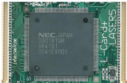
写真2 NEC VR4181 MIPS互換のRISCアーキテクチャを採用したポケットPC用の多機能マイクロプロセッサ。
