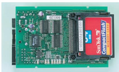
写真1 L-CARD+は、名刺サイズでLinuxが走るコンピュータ
