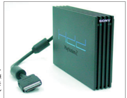
写真4 ハードディスクユニット 電源スイッチはついておらず、カーネルが読み込まれると自動的に電源が入っている。ファンを内蔵しているが、こちらもカーネルが読み込まれるまで回らない。
