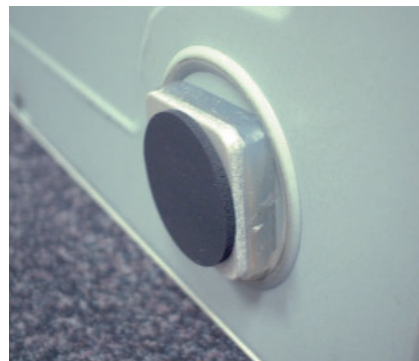
写真9 V-Chipで作った「足」 V-Chipに同梱のウレタンを貼り付けてケースの足替わりにしてみた。シールが付いているので取り付けは簡単。現在、これ以外の使い方を随時メールで受付中(ウソ)。
