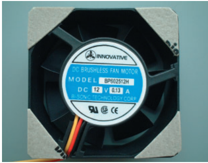
写真10 CPUファンに取り付けた制振シート ご覧のように接触面は少ないものの効果は「アリ」。完全に音がなくなるわけではないが、耳障りな雑音がカットされる。ケースファンと電源ファンにも同じ処置を施した。
