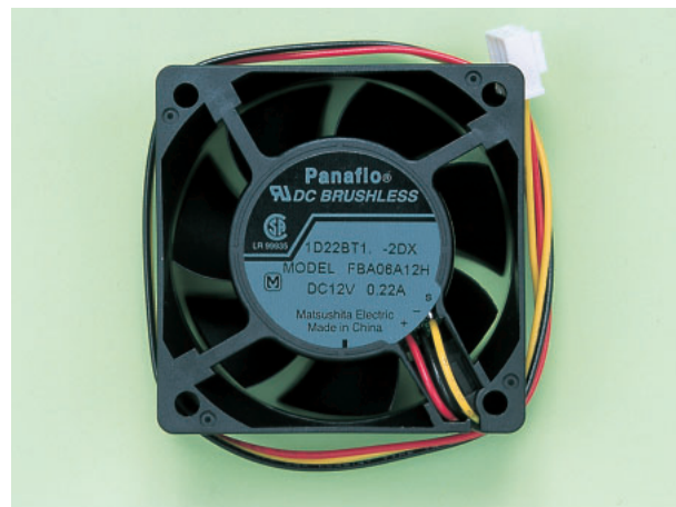
写真8 松下電器産業製、Panafloの60mmファン 流体軸受けを採用し、回転数は4200rpm。CPUクーラーのファンを交換するために高速電腦で購入。パルスセンサ付きの3ピンタイプでBIOS画面などで回転数をモニターできる。流体軸受けの静音効果がいかに。価格は2500円。
