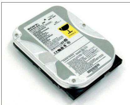
写真6 ハードディスクドライブ SONYのロゴが記載されているものの、dmesgの出力を見る限りSeagateのST340823Aだと思われる。なお、分解するとメーカー保証対象外になるので注意されたい。
