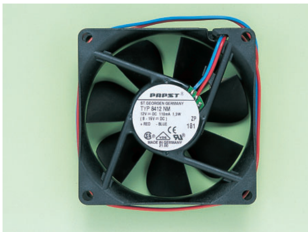
写真1 ドイツPAPST製の80mmファンVARIOFAN（中速） 回転ムラをなくすために、小さな錘でバランス取りを行っている。パルスセンサなしの2ピンタイプなので、BIOSで回転数を検知することはできない。今回は、1500rpm（超静音）、2600rpm（中速）を購入した。高速電腦で各2980円。
