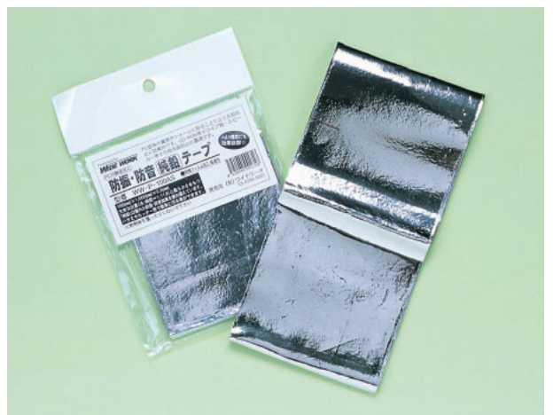
写真6 防振・防音 純鉛テープ 「鉛色」という表現があるが、これはどうみても「銀色」である。純度の高い鉛はこういう色なのだろう。0.3ミリと薄く、ハサミやカッターで簡単に加工できる。また、裏面にシールになっている。製造・販売元はワイドワーク、100×1000ミリで1400円。
