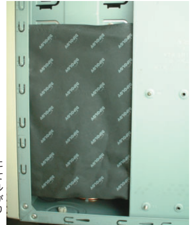
写真4 吸音フィルムはケースのすき間に説明書きに「振動しやすい状態に」してほしいとあったので、このようにフィルムの端のみテープで固定した。残念ながら今回は効果を発揮しなかったが、取り付け方を考えればあるいは……。
