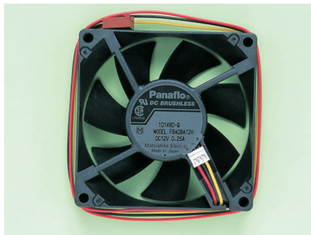
写真2 松下電器産業製の80mmファンPanaflo（2950rpm） ボールベアリングよりも摩擦、騒音が少ないとされる流体軸受けを採用した冷却ファン。パルスセンサ内蔵の3ピンタイプ。今回は、1900rpm（静音）、2950rpmのものを購入した。高速電腦で各2800円。
