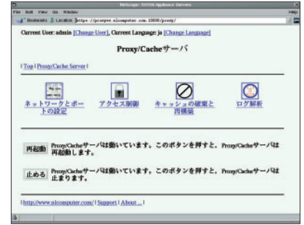
画面1 Proxy/Cacheサーバのメニュー プロキシ機能の動作のON/OFFのほか、ネットワークポートやアクセス制御の設定とログ解析が行える。
