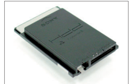
写真5 ハードディスク+ネットワークインターフェイスカード このカードを経由して、ハードディスクユニットとネットワークケーブルを接続する。残念ながら、PCカードのため、ハードディスクの転送速度は遅い。
