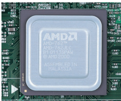
写真2 AMD-760MP ノースブリッジのAMD-762。外観はAMD社のK6シリーズによく似ている。
