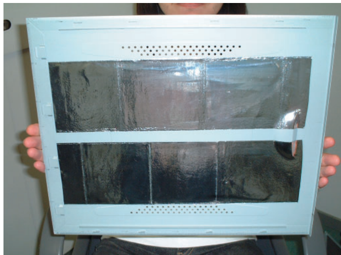
写真7 ずっしりと貼り付けられた純鉛シール 全面に隙間なくびっしり貼り付けるといふ案もあったのだが、めんどくさかったので、こんな感じに。これでもかなりの重さである。フルタワーケースではどれくらい重さになるのやら。
