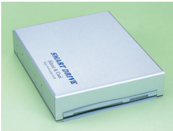
写真11 ハードディスクの静音化アイテムSMART DRIVE 3.5インチのハードディスクを収納するアルミのケース。リボンケーブルと電源ケーブルは写真手前にあるシリコンゴムの隙間から外部に引き出す。ソフマップにて、6479円で購入した。ちょっと高い？
