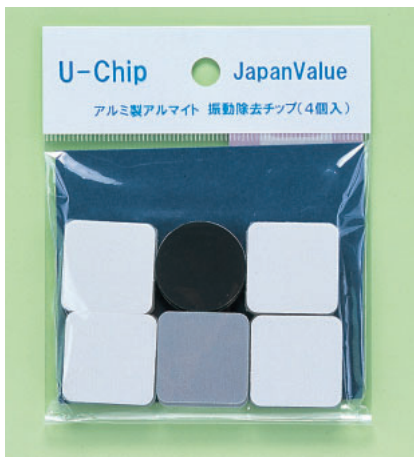
写真8 振動吸収ゲルチップ アルミ板に振動を吸収する特殊ゲルを貼り付けたもので、ゲルの柔らかさが違う「V-Chip」と「U-Chip」がある(写真はU-Chip)。どちらも、25ミリ四方で厚さ7ミリ、同じ大きさのアルミ板(厚さ2ミリ)と円形のウレタン(厚さ1ミリ)が同梱されていて、価格は1980円。発売元はJapanValue。
