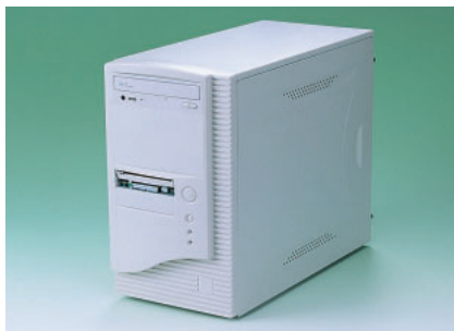
写真1 4万円PCプロジェクトで購入したケース高さはわずかに35cmと、ATX電源を内蔵するケースとしてはきわめて小さい。これがアダとなり、音だけではなく、熱の対策にもアタマを痛めることになる。
