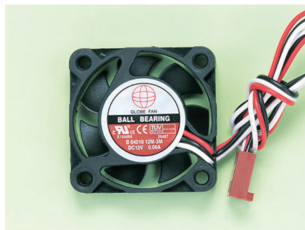
写真10 Justyブランドの40mmファン チップセットクーラーのファンを交換するために購入した。軸受けは、一般的なボールベアリング。元から付いているファンより静かになるかはわからない。回転数は5000rpmだ。T-ZONEで1580円だった。
