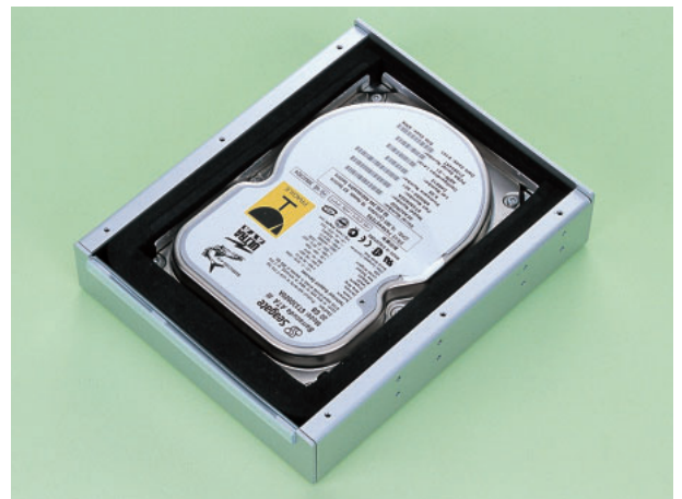
写真12 SMART DRIVEにハードディスクを入れたところ SMART DRIVEの内部には、ハードディスクをピッタリと覆うように吸音材が張られている。フタを閉めたら、ケースの5インチベイに取り付ける。アルミでできているため、ドライブの放熱にも効果があるという。
