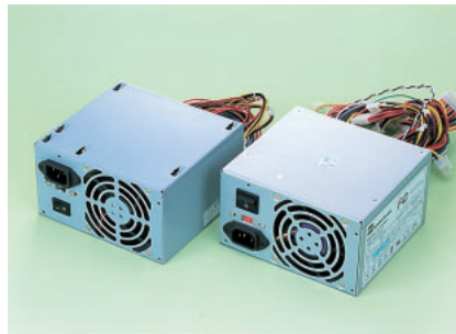
写真2 電源ユニット 左は5980円のケースに付属していた電源。右はソフマップにて6999円で購入したSeventeam ST-300BLVという300W電源。これで、取り出せる電力が倍増する。
