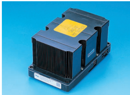
写真3 Itanium 3次キャッシュを統合するため、小型のハードディスクのような外観を持つ。
