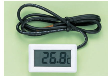
写真3 FILCOの温度計 ケーブルの先にサーミスタが付いており、これをテープで貼り付けて使用する。-40 ~ 100 の範囲を0.1 単位で測定可能。高速電腦で1980円。
