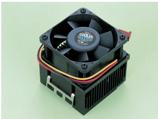
写真7 COOLER MASTER DRACO THUNDERBIRD (DP5-6HD1) 1.2GHzまでのAthlon、Pentium に対応する。60mm角、25mmのファンでCPUを強力に冷却するが、その高さは65mmにもなるので、取り付けスペースがあるかどうかをよく調べよう。高速電腦にて3500円で購入。音はかなりうるさい。
