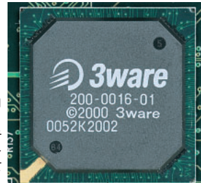
写真2 ディスクコントローラ 型番は200-0016-01。1チップで4ポートをサポートするので、2個搭載されている。
