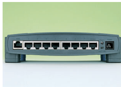
写真4 ブロードバンドルータ（背面） この機種は8ポートの10BASE-T/100BASE-TXのスイッチングハブが内蔵されている。ルータ兼ハブという構成だ。
