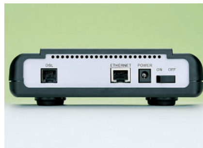
写真2 ADSLモデム（背面） 左のADSLインターフェイスをADSLスプリッタと接続する。右が10BASE-Tのポート。
