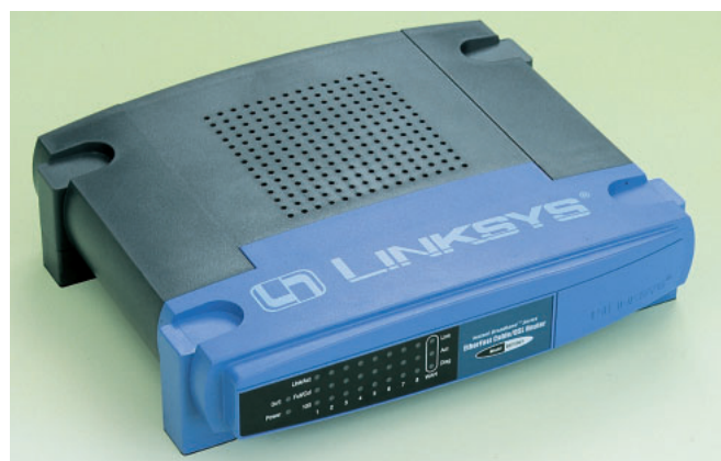
写真3 ブロードバンドルータ LINKSYS BEFSR81。ブロードバンドルータ（DSLルータ）は、PPPoEクライアント機能が内蔵されているため接続が簡単になる。IPアドレスの共有や、ファイアウォールとしても機能する。
