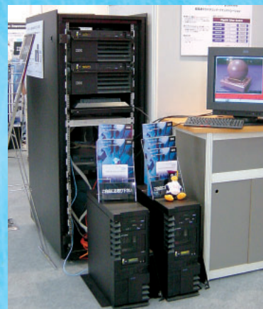
IBM pSeriesを4台使用したクラスシステムで3Dアニメーションのレンダリングを行っていた。OSはAIXではなくSuSE 7.1のPowerPC Editionで動作していた。
