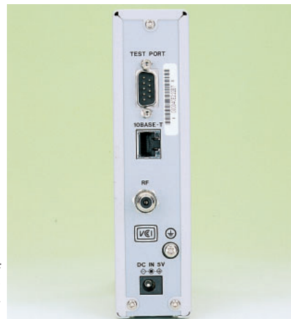
写真6 ケーブルモデム（背面） 中央が10BASE-Tコネクタ。下がRF 端子で、ここにCATVのRF同軸ケー ブルを接続する。上のコネクタはメ ーカ調整用で通常は使われない。
