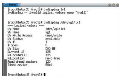
画面6 論理ボリュームの確認 論理ボリュームの情報は、lvdisplayコマンドで確認する。
