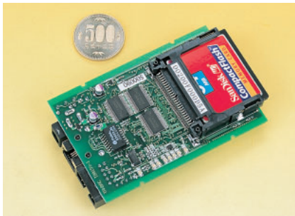
写真1 コンパクトフラッシュを装着したL-Card + 組み込み用途のためむき出しのボードで提供される。500円硬貨と比べても、L-Card + の小ささがよくわかる。
