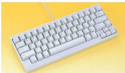
写真1 英語 (UNIX) 配列のLite 2 右下にカーソルキーが追加された。ほかのキートップに比べてかなり小さい。ファンクションキーはFnキーと1~4キーとの組み合わせで打鍵する。
