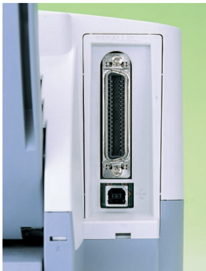
写真4 BJ F870のコネクタ PM-780Cと同様に、パラレルとUSBのコネクタを持つ。
