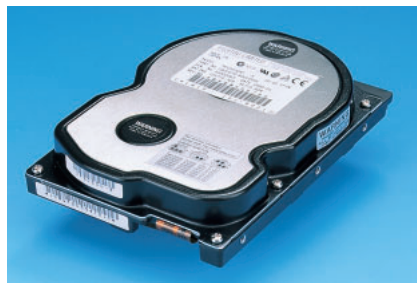
写真21 絶滅寸前の「小」容量HDD 奇跡的に保護された富士通の3.2Gバイトハードディスク(MPC3032AT)。製造年月は意外に新しく2000年1月とプリントされていた。
