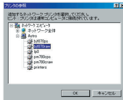
画面 18 プリンタ参照画面 Sambaでの設定が正しければ、プリンタが表示されている。
