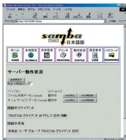
画面9 「動作状況」画面 smbd / nmbdの起動・停止、接続中のクライアントの確認が行える。Samba運用中のモニター画面ともなる。
