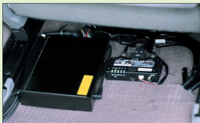
運転席の下の車載システム。集めたデータはDoPaを使って送られる。
