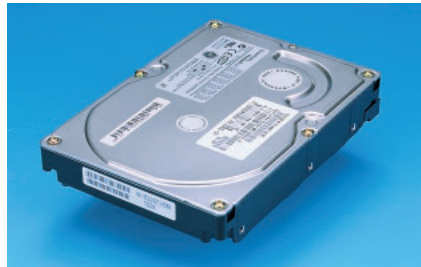
写真8 Quantum Fireball lct2010 容量は10.2Gバイト。シークタイムは12ms、キャッシュは128Kバイト。Quantumのハードディスク部門はMaxtorに買収されたので、MaxtorのWebサイトにあるデータシートを参照したところ回転数7200rpmとなっているが、4500rpmだと思われる。UltraDMA/100対応製品。
