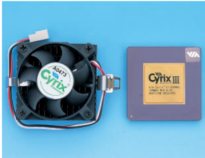
写真9 VIA Cyrix プロセッサ リテールパッケージにはイカすファンが付いている。かなり小さめのファンなので、発熱量が少ないと予想される。セラミックパッケージが高級感を漂わせている。
