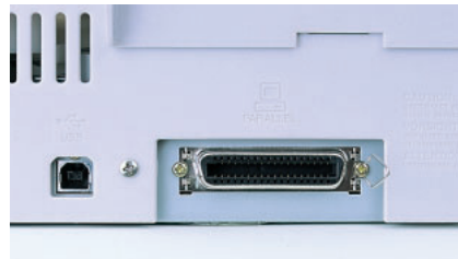
写真2 PM-780Cのコネクタ パラレルとUSBのコネクタを備え、幅広い機種に対応可能。
