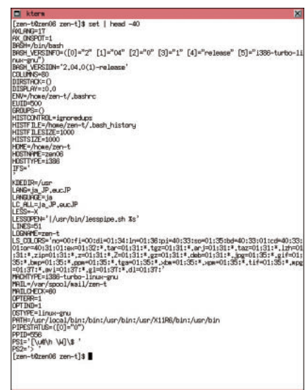
画面5 シェル変数の一覧を表示させる setコマンドを使えば、その時点で使われているシェル変数の一覧を見ることができる。
