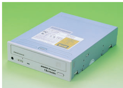
写真1 動作確認に使用したCD-R/RWドライブ LITEON ITというあまり馴染みのないメーカーの製品。CD-R 12倍、CD-ROM 32倍、CD-RW 10倍で、BURN-Proofにも対応しているながら、1万5980円という格安ドライブだ。
