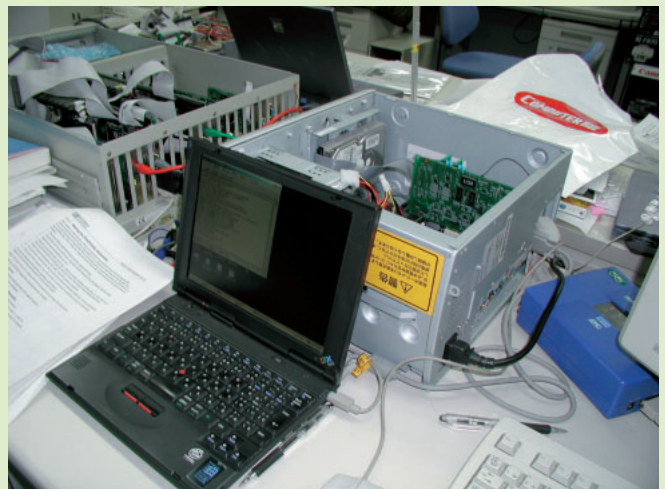
写真2 L-BoardへのLinuxのボーティング（移植）作業風景
