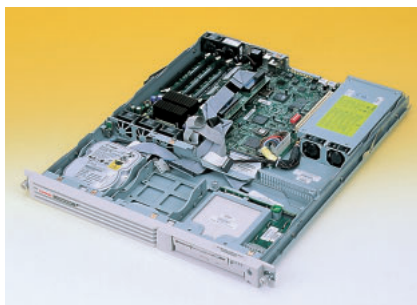
写真1 ProLiant DL320 1UラックマウントサーバProLiant DL320に、リモートInsightボードLights-Out Editionを装着して試用した。
