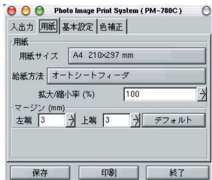
画面5 pips780の[用紙]タブ 用紙サイズをはじめ、拡大/縮小率、マージンを設定する。[給紙方法]はオートシートフィーダのみ選択可。
