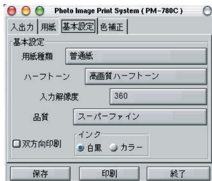
画面6 pips780の[基本設定]タブ 用紙の種類、解像度、プリント品質などを指定。720Cでは、[双方向]をオンにしないほうがよい。
