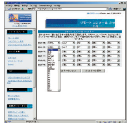
画面5 リモートコンソールのホットキーの設定 CtrlとAltとファンクションキーのように複数のキーを同時に入力したい場合には、ホットキーを利用する。
