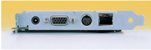
写真2 リモートInsightボードの外部出力 左から、外部電源入力、VGA出力、PS/2、LANコネクタ。他のPCからこのLAN経由でサーバを監視/管理できる。
