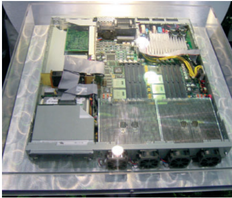
ついにAlphaプロセッサまでが、1Uサーバの筐体に！（しかも2個）833MHz x 2のAlphaによって、他を圧倒する数値計算能力を誇っている。
