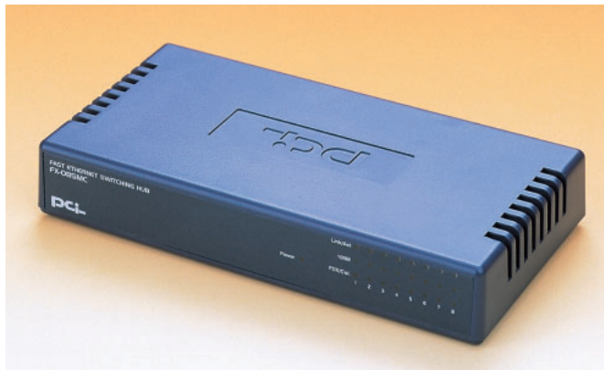
写真3 スイッチングハブ 編集部で使用しているプラネックス FX-08SMCは、筐体の背面に8つのイーサネットポートを備える。製品によっては、ポートが前面のものもある。状況に合わせて選択しよう。
