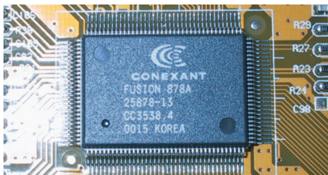
写真1 BT8x8シリーズの例「Fusion 878」 Brooktree社がCoexant社に買収された結果、「BT8x8」シリーズの名称は「Fusion 8x8」に変更されている。写真は、もっともよく使われている「Fusion 878A」。
