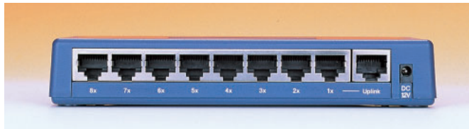
写真4 FX-08SMCの背面 左から8つのイーサネットポートが並んでいる。9つめはカスケードポートといい、ハブを多段接続する場合に利用する。このポートは8番目のポートと排他利用しなければならない。
