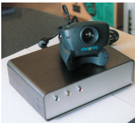
写真6 完成した防犯カメラサーバ（前） 市販のカメラやボード、筐体を利用することで、コストダウンを図った。
