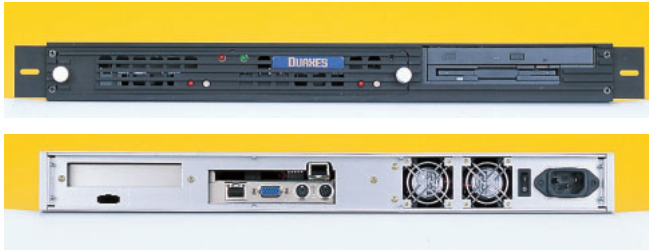
写真2 本体前面と背面コネクタ フロントパネルのネジを外すと、前面部分からハードディスクを引き出して、簡単に交換できる。背面には、ネットワーク×2、VGA出力、PS/2×2ポートが用意されている。
