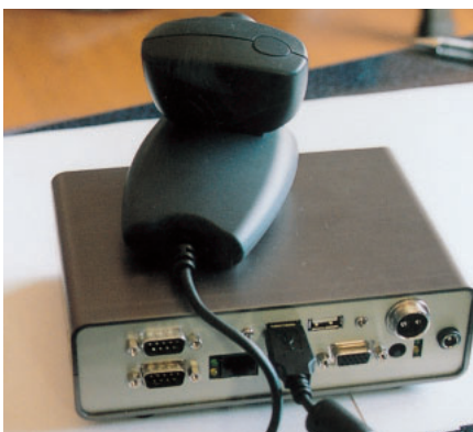
写真7 完成した防犯カメラサーバ（後） このシステムを自動販売機に組み込むことで、異常時に撮影した画像をメールでオーナーに送信することができる。
