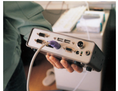
写真5 接続されたコネクタ コネクタを保護するプラスチックの大きさを考慮することで、きちんと接続が可能となった。
