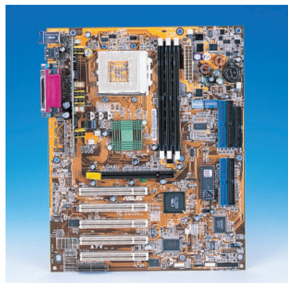
写真6 ASUS A7V/WOA Athlon/Duron用チップセットで最も人気の高いKT133を採用している。
