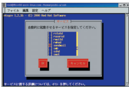
画面10 ntsysvコマンドによるsendmailデーモンの起動
