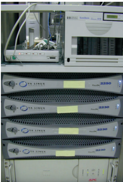
コンピューターセンター内に設置されたVAのシステム。4台の「VA Linux 2200」のほか、テープドライブやUPSなどが1つのラックに収納されている。
