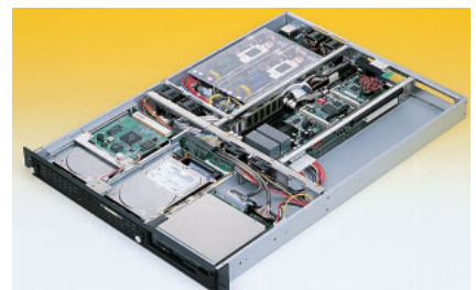
写真1 DUAXES AS-701Rの本体内部 日本製アルミシャーシを採用し、1Uサイズながら十分な放熱性を確保している。電源は大容量300Wを採用。
