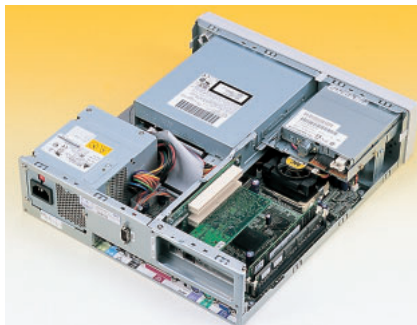
写真1 SURFNAVIの内部 コンパクトPCとほぼ同じ部品構成である。
