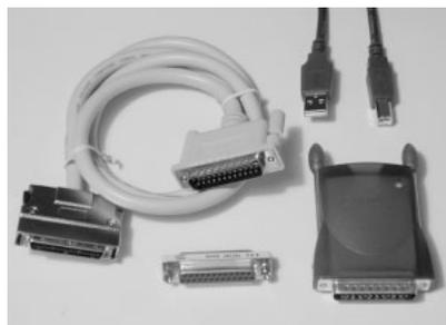
写真5 Xircom製USB-SCSI変換ケーブル
