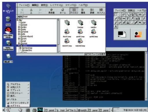
画面5 ウィンドウマネージャがなくなったGNOMEアプリケーション。ウィンドウの枠がなくなり、ウィンドウの移動やサイズ変更ができないが、ウィンドウ内の各機能は正常に働いている。
