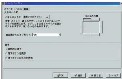
画面4 [ パネルのプロパティ ] ダイアログボックスでは、パネルの方向 ( 水平・垂直 ) や、画面の端からのオフセット値を設定することができる。
