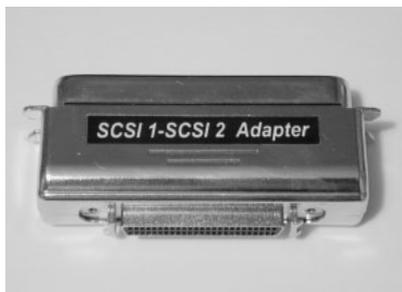
写真4 フルピッチとハーフピッチの変換コネクタ
