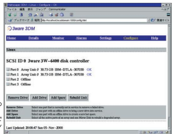
画面5 管理ツールの「Configure」画面 Linuxを動作させたままRAIDアレイのメンテナンスができる。
