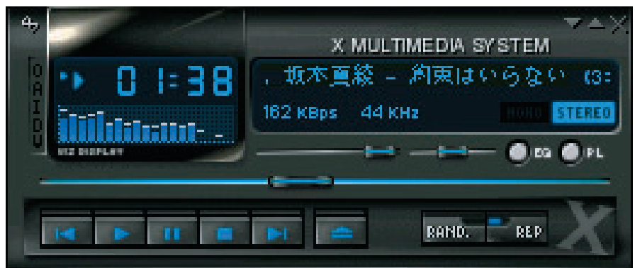
画面3 XMMSでOggファイルを再生中。ビットレートが刻々と変化する。
