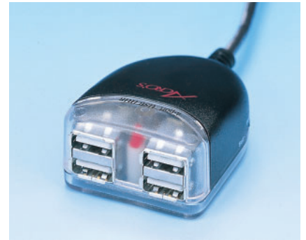
写真4 USBハブのポート部分 ハブからも電源は供給されるが、デバイスによってはACアダプタが必要な場合もある。ちなみに、このコネクタ形状がUSB-Aタイプのメス。
