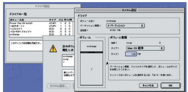
画面2 「ドライブ設定」(Drive Setup) によるパーティション設定 Mac OSに標準付属するディスクフォーマット/パーティションングツールを使って、Linux用にパーティションを抽出する必要があります。この例では4GバイトのハードディスクをMac OS用に1Gバイト、Linux Swap用に128Mバイト、Linux / (root) 用に2.9Gバイト割り当てるように再フォーマット/パーティションしようとしています。
