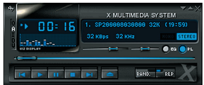
画面1 XMMSの「スペクトラムアナライザ」 XMMSの情報ディスプレイ部分でマウスを右クリックし、[Visualization Mode] - [Analyzer]を選択すると、再生中の音声の周波数帯域ごとのレベルが表示される「スペクトラムアナライザ」モードになる。レベル表示のバーが常時振り切れていて、レベルの変化がわからないような状態だとレベルオーバー、スペクトル分布がだいたい判別できるような状態が適正レベル、というように判断することができる。ただし、このアナライザはあくまで「参考」程度にしかならないので、最終的には再生音を聞いて、自分の好みに合わせた設定を行うしかない。
