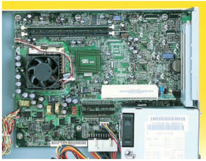
写真1 Altos SA50のマザーボード マザーボード上の写真右側には、通常あるべきVGA出力用などの部品が載っていない部分が多い。
