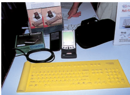
PFUアメリカブースで発見した完全防水型キーボード。黄色いゴムでキー・スイッチが裏側まで完全に覆われていて、巻いて持ち運びも可能。そういえばこのスケルトンタイプが秋葉原で売られていたような？
