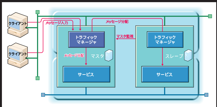
図3 スケラビリティクラスタ最小構成例 トラフィックマネージャとサービスノードを1台のマシンで行えば、最低2台からクラスタを構成できる。
