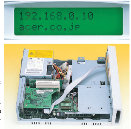
写真3 液晶表示部とAltos SA50内部 16文字×2行のLCDディスプレイにシステムステータスを表示する。LCDへはDOCカードからケーブルで接続されている。
