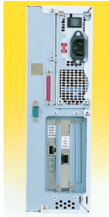
写真2 Altos SA50背面コネクタ キーボード、マウス、VGAモニタなどのコネクタはなく、各種設定はLANで接続した別のPCから行う。
