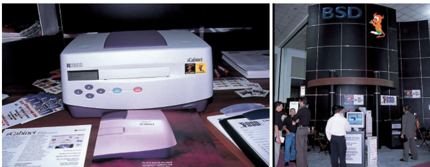
BSDブースで発見した、FreeBSD組み込みのドキュメントファイルサーバ。ネットワークに接続するだけでファイルサーバとして機能する。リコー・アメリカ製。
