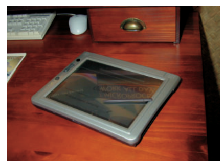
WebPadは非常にコンパクトながら、PCカードスロットやUSBインターフェイスを備えている。LCDには、タッチパネルが装備されており、ソフトウェアキーボードで文字入力も可能。
