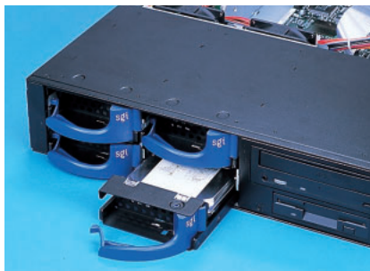
写真10-1 ホットスワップ可能なドライブベイ 本体カバーはフロント部分を除いて開くようになっている。4台分のUltra160 SCSI対応ドライブベイを持つ。
