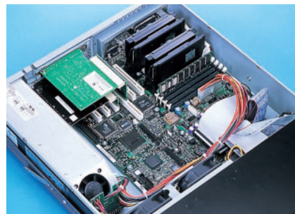
写真10-2 SGI 1200のマザーボード オンボードに機能を盛り込んでいる。PCIスロットに挿入しているカードはテストのため標準では空き。
