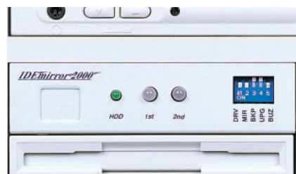
写真2 ミラーリングを行うIDEmirror2000 IDEハードディスクのミラーリングはIDEmirror2000が行う。ホットスワップに対応し、故障交換後のディスク再構成も自動的に行われる。
