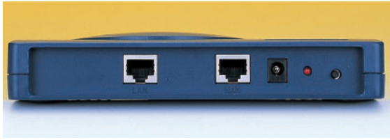
写真1 BRL-01の背面 左からWAN側ポート（ケーブルモデムなどの接続）、LAN側ポート、電源コネクタ、パワーLED、リセットスイッチ。電源スイッチは付いていない。
