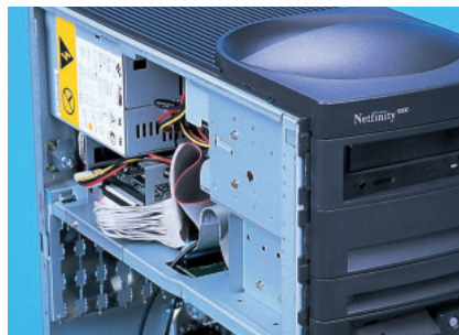
写真12-2 本体上部にある電源とドライブベイ ドライブベイには、5インチベイ1台と3.5インチ2台分の空きスペースがある。
