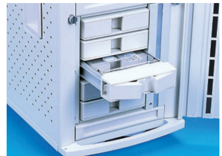
写真5-2 NL Server 3000のドライブベイ 標準でRAID5をサポートし、SCSIハードディスク5台まで装着できる。故障時にはホットスワップが可能。
