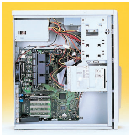
写真1 ケース側面を開けたところ ヒートシンク付きファンのみでクーリング対策を行っている。発熱はさほど大きくない。
