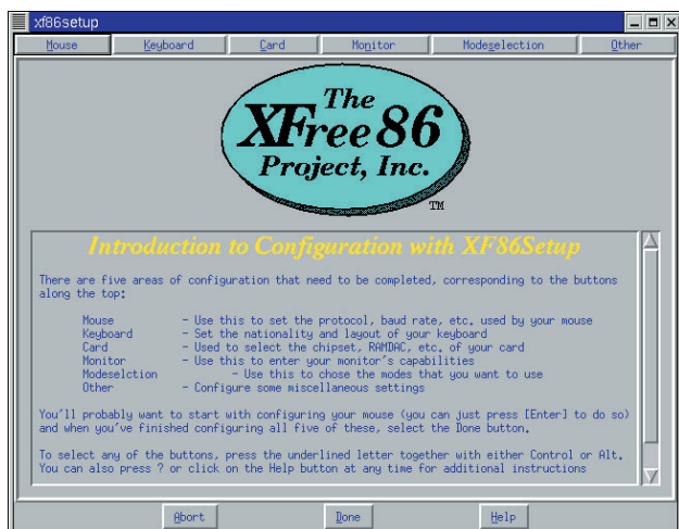
画面1 XFree86Setupの起動画面 XがVGA 16色モードで起動し、GUIで設定できる。
