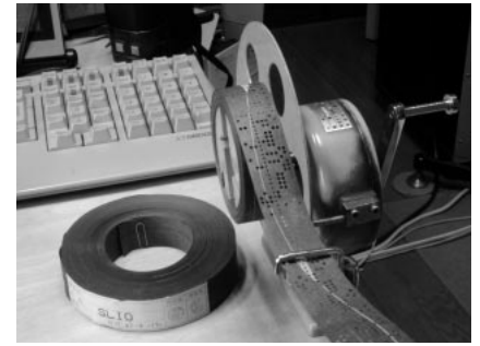
写真1 紙テープとリワインダ 付録CD-ROM No.4にカラー画像データを収録。
