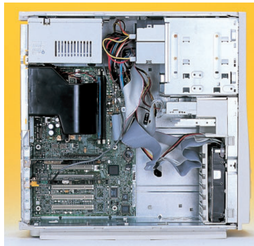
写真4 ケース側面を開けたところ 巨大な排気ダクトが目立つ。この ダクトで強制排気している。
