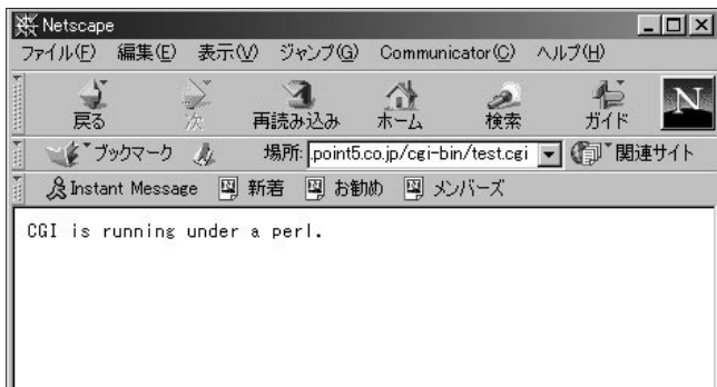
画面2 mod_perlが組み込まれていない場合のtest.cgi実行結果
