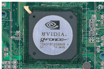
NVIDIA GeForce256 PC用アクセラレータで、ハードウェアによるジオメトリ演算を可能にした最初のチップだ。
