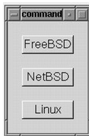
画面2 GTK+を使用したボタンを表示するプログラム。今月号の付録CD-ROMに収録されているgtktest.cを「make」でコンパイル・実行した結果の画面。
