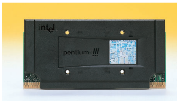
写真7 1GHz Pentium III Coppermineコアを採用。コアダイに2次キャッシュを内蔵して高速化している。
