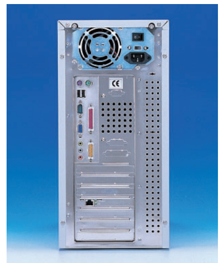
写真9 完成図 - その2 背面である。ショップの勧めに従って、NICはPCIスロット3に装着した。
