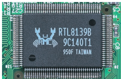
Realtek RTL8139B 周辺チップを統合し、低価格化を実現している。
