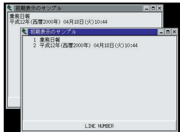
画面4 例04の実行例 ON OPEN イベントハンドラを使うことで、ダイアログボックスの初期状態（この例では日時などの文字の入力）を設定している。
