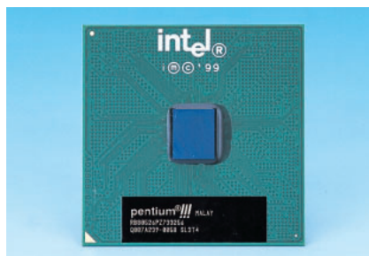
写真5 Pentium 733MHz 基板上にチップが剥き出しになっているため、従来のCeleron用のファンの流用はできない。
