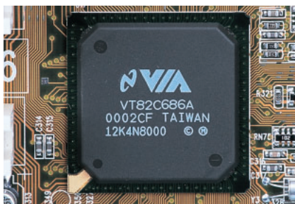
写真4 VT82C686 スーパーサウスと呼ばれるI/Oコントローラ。UltraDMA/66、AC'97 Digital Audio、USB、PS/2キーボード/マウスをサポートする。
