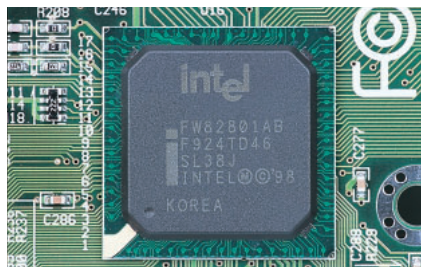
写真11 82801AB i810チップセットのI/Oコントローラハブ。問題のUltraDMAとサウンド機能を制御するチップである。
