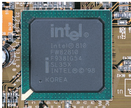
写真6 82810チップ i810チップセットのメインチップ。グラフィックメモリコントロールハブ (GMCH) と呼ばれるとあり、ビデオ機能が統合されている。
