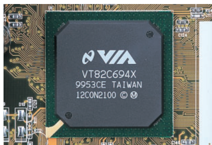
写真3 Apollo Pro133A (VT82C694X) FSB 133MHz、AGP 2X / 4X、PC133 SDRAMをサポートする。
