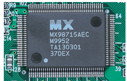
Macronix MX98715A DEC 21140の互換製品であり、tulipが利用できる。
