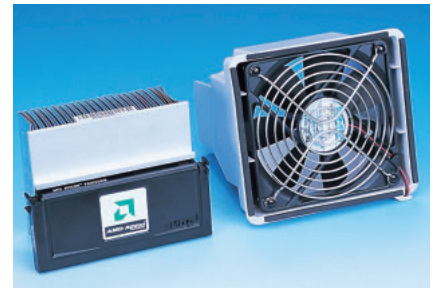
写真5 CPUとケースファン CPU本体と同じくらい巨大なヒートシンクが目につく。キットに付属のケースファンも大型のものだ。
