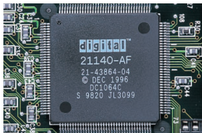
DEC 21140-AF 幅広いIOSに対応しており、マルチブートPCにも適している。
