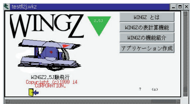
画面13 ON REPAINT イベントハンドラによる描画の例 画面上の飛行機は、マウスのドラッグ操作によって発生するイベントにより視点を変更する処理が行われ、マウスボタンを放したタイミングで再描画される。
