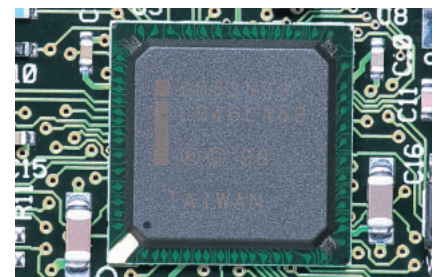
i82559 チップセットでおなじみのBGAパッケージだが、サイズは非常に小さい。
