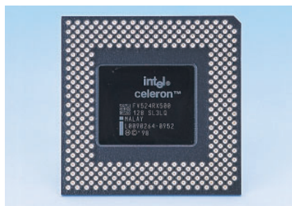
写真2 Intel Celeron 500MHz CPUとマザーボードの互換性にも注意が必要だ。ソケットの種類を事前に必ず確認すること。
