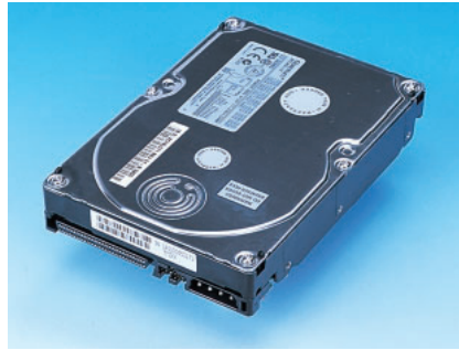
写真9 Quantum ATLAS V 18.3S Ultra160SCSI対応のハードディスク。7200RPM、平均シーク時間6.3m秒、キャッシュ容量4Mバイト。
