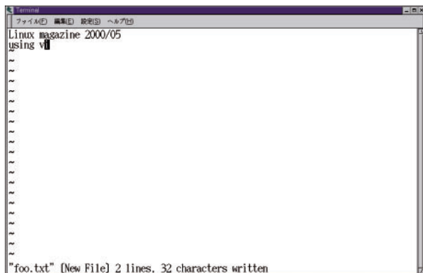
画面3 画面の下に保存したファイルに関する情報が表示される
