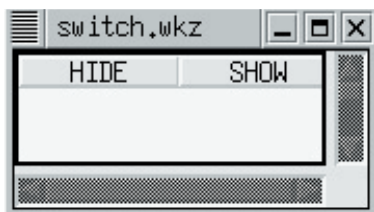
画面 12 例 07 の switch.wkz ワークシート TARGET WINDOW コマンドで対象ウィンドウを切り替え、ウィンドウの表示/非表示を行います。
