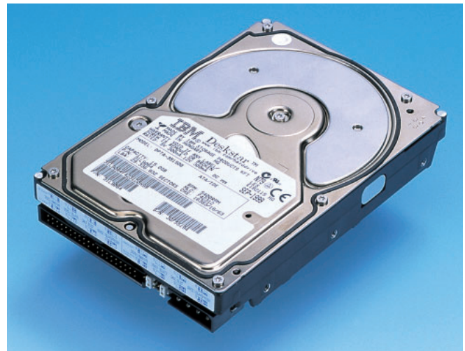
写真2 今回使用したIBMのDPTA-351500。15GBバイトの容量を持ち、回転数は5400rpmのタイプ。
