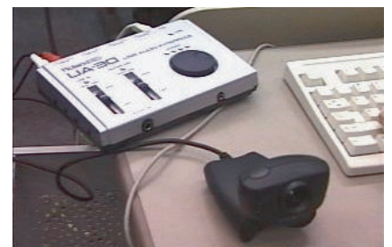
画面6 NLUG勉強会の中継に使用したUSBデバイス 中継に使用したCreative LabsのUSBカメラ「WebCam 3」(手前)とRolandのUSB音源「UA-30」(奥)。
