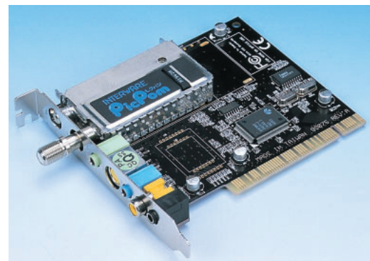
写真2 PicPom Linuxのカード TV/FM出力端子のほかS-VHS入力端子、サウンドの入出力がある。音声出力は、サウンドカードへ接続する。
