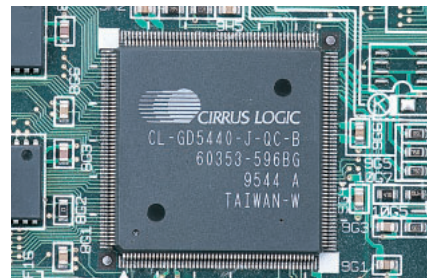
写真3 グラフィックスアクセラレータはCirrus LogicのCL-GD5440だ
