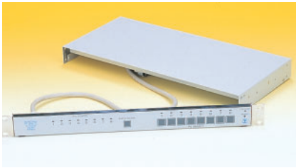
写真1 ラック取り付け時には分離可能 スイッチパネル部とコネクタ部が分離できるため、19 インチラックに取り付ける時の作業が楽。高さはわず か42mm(1Uサイズ)と薄いので場所を取らない。
