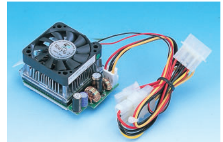
写真5 アイ・オー・データ機器のPK-K6H400/DV AMD K6-2 400MHzを採用したCPUグレードアップキット。電源から12Vの供給を受け、レギュレータが必要な電圧に降圧してCPUを動作させる。
