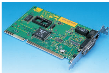
写真7 ネットワークカード 定番ネットワークカード3Com EtherLink III。ISDNダイヤルアップルータが10BASE-T対応なのでこれで十分だ。
