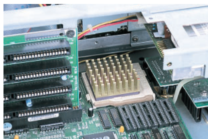
写真2 486DX 100MHz FSBは33MHzで、コアは3倍の100MHz。
