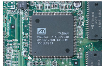
写真5 マザーボード上のMach64チップ XFree86での動作も確認されており安心。グラフィックスメモリ2Mバイトは、ちょっと頼りない。
