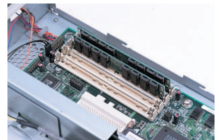
写真4 SIMMスロットは4本うち2本に4MバイトSIMMが装着されているので2本空きがある。
