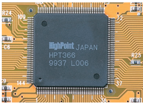
写真14 HighPoint Technology社のHPT366チップ ABITのマザーボードにもオンボード搭載されているメジャーなチップだ。
