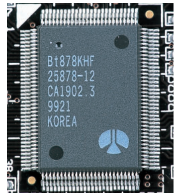
写真3 Conexant Bt878 Bt84xシリーズの改良版となるコントローラチップ。
