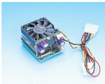
写真11 メルコ HK6-ms V2 K6-III搭載のCPUアップグレードキット。FSB66MHz時は400MHzで動作する。購入価格2万6600円
