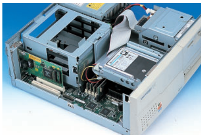
写真2 PC-9821 V13のケースを開けたところ 感電しないように電源コードを抜いておこう
