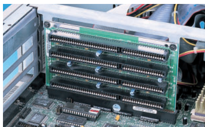
写真3 ISAのみの拡張スロット 最近のマザーボードには、PCIのみの製品もあるので、ISAスロットを見たことがない人もいるのでは？
