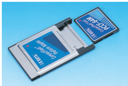
写真 コンパクトフラッシュとPCカードソケット PCカードソケットに装着することにより、Linux上からもコンパクトフラッシュ上の画像データにアクセス可能となる。写真は、アイ・オー・データ機器のPCCF-64M（3万1000円）。
