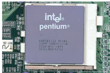
写真4 Pentium ( P54C ) 133MHz セラミックのPGAパッケージが懐かしい。実際に装着されているときは大きなヒートシンクがついているので、この面は見えていない。
