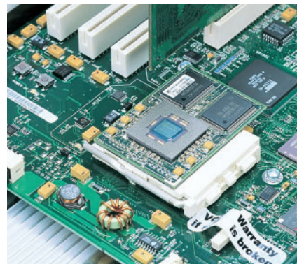
写真2 PowerPC750（G3） 「G3」は「Generation 3」、PowerPC系CPUの第3世代の意味。インテルのPentiumIIIなどと同じように、2次キャッシュ専用のバスを持つことで大幅に性能を向上させた。またx86系CPUと比較して、消費電力が低いのも特徴だ。
