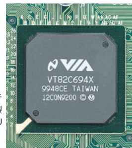
写真1-9 Apollo Pro 133A PC133 SDRAMをサポートする数少ないチップセット。VIA Technologiesが開発・製造しており、AGP 4xやUltraDMA/66、USB × 4ポートにも対応する。
