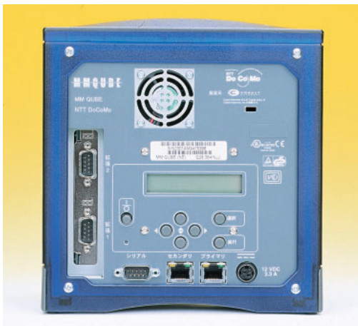
写真1 MM QUBE背面 ベースはCobalt Qube2だが、PCIスロットにシリアルインターフェイスカードを増設している。キーボードやマウスのコネクタは存在しない。すべてはLAN経由で制御する。
