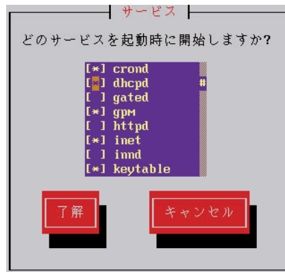
画面3 ntsysv（サービスの設定）LASER5 Linux 6.0のコンソールから、ntsysvコマンドで起動時に実行するサービスを設定する。
