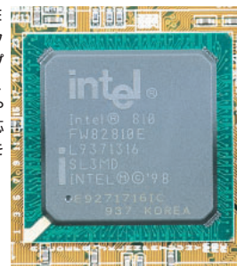
写真1-10 i810E 今回唯一のグラフィックス統合チップセット。Intel製で、133MHzのFSBやUltraDMA/66対応など、i820の機能を先取りしていた。
