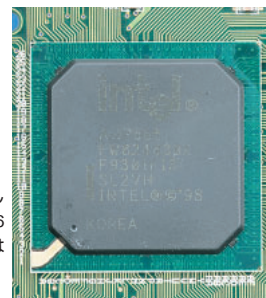
写真1-7 440BX 2年近く前から現役という珍しく長生きしているIntel製チップセット。UltraDMA/66非対応と仕様は古くさいが、安定性には定評がある。
