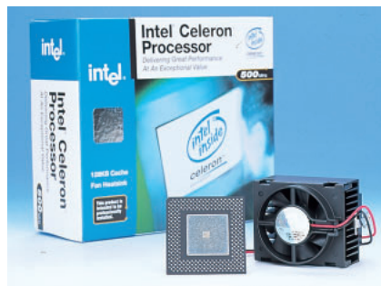
写真2-3 購入したリテール版Celeron PPGAパッケージで500MHzのモデルを1万4800円で購入した。Pentium III同様、バルク品+ヒートシンク付きファンよりリテール版のほうが安価なことが多いが、リテール版に同梱のファンは回転速度を検出できない廉価なタイプである。
