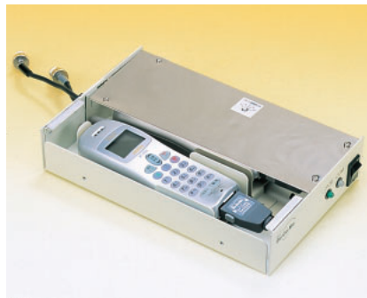
写真4 PAUに組み込む内蔵用携帯電話 携帯端末からこの携帯電話にアクセスすることで、 MM QUBEとメールのやりとりができる。
