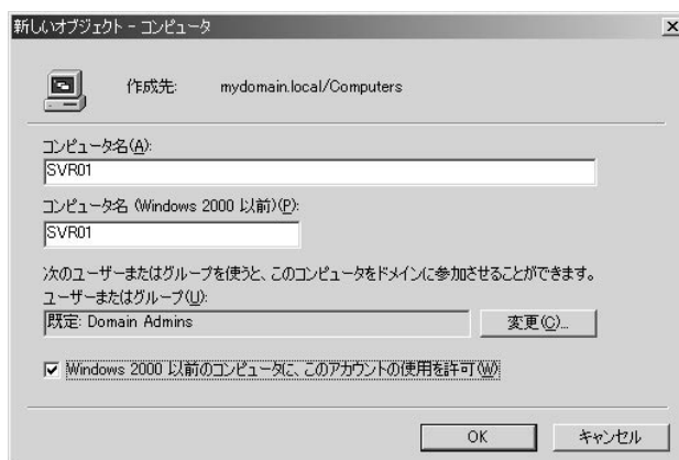
画面2 Sambaサーバーの登録 現在のSambaはNT 4.0互換なので、コンピュータの登録もそれに準じたものとする。
