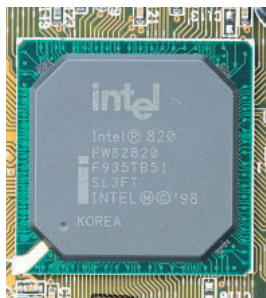
写真1-8 i820 初めてDirect RDRAMをサポートしたIntel製チップセット。最新の各種規格をサポートするほか、PC100 SDRAMもオプションで接続できる。
