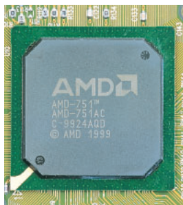
写真1-6 AMD-750 これまで唯一のAthlon用だったAMD製のチップセット。FSBは200MHzと高速だが、メモリはPC100までである。SMPには対応していない。
