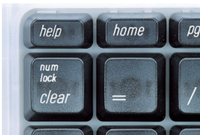
写真6 マウスボタンの代わりに使うキー たいていの人が右手でマウスを扱う。ということは、これらのキーは左手で押すことになる。やってみれば分かるが、非常につらい姿勢になってしまう。
