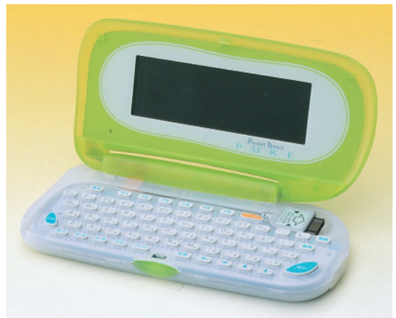
写真2 ポケットボードビューア 非常に軽量コンパクト（重さ199g）で、液晶は25文字（全角）×7行表示が可能。携帯電話につないでメールの読み書きができる。
