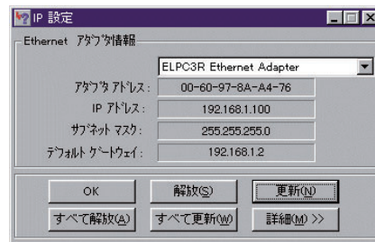
画面2 Windows 95でwinipcfgを実行したところ「すべて解放」で取得したデータを無効にし、「すべて更新」でネットワーク設定をDHCPサーバから取得する。
