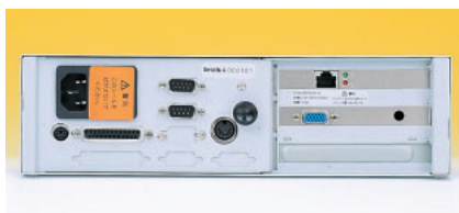
写真3 本機の背面パネル 通常のPCと同様のコネクタが並ぶが、通常はシリアルポートやパラレルポートを使うことはないだろう。キーボードは標準DINコネクタで接続する。
