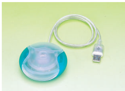
写真5 アップル純正USBマウス MacOSで使うには、適切な1ボタンだが、X Window Systemで使うにはまったく向いていない。
