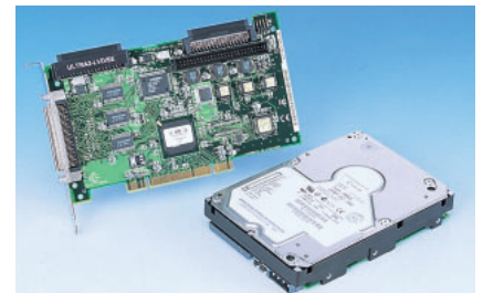
写真5-1 比較対象のSCSIシステムハードディスクはIBM製Ultrastar 18LZXの9.1Gバイトモデル、ホストアダプタはAdaptec製AHA-2940U2Wだ。SCSIバスの転送レートは最大80Mバイト/秒とUltraDMA/66より高速である。
