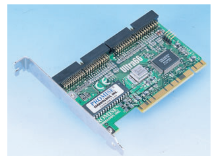
写真3-2 IDEコントローラカードのPromise Ultra66 (実売価格: 約6000円) UltraDMA/66対応のIDEインターフェイスを2ポート装備するPCIカード。コントローラチップは同社製PDC20262で、市販のマザーボードにはこれを装備してUltraDMA/66対応とした製品もある。
