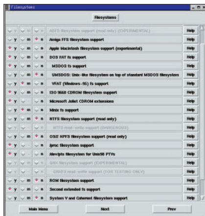
画面9 xconfigによるカーネルのコンフィグレーション画面。 Linuxはいろいろなファイルシステムをサポートしている。
