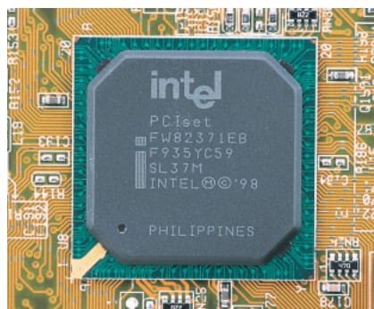
写真3-1 IDEコントローラチップのIntel PIIX4E 正確にはIDEコントローラだけではなく、USBインターフェイスなども集積されているチップで、Intel 440BXチップセットの一部だ。Ultra DMA/33対応のIDEインターフェイスを2ポート内蔵する。
