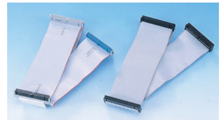
写真2-1 UltraDMA/66対応(左)と非対応(右)のケーブル
