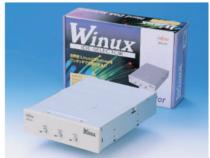
写真4-1 Winux 最大3台のIDEハードディスクを切り替えて起動できるハードディスクセクタ。マルチOS環境を常用する場合、安全にOSを切り替えられる。IDEの転送モードなどには一切関係なく使える。
